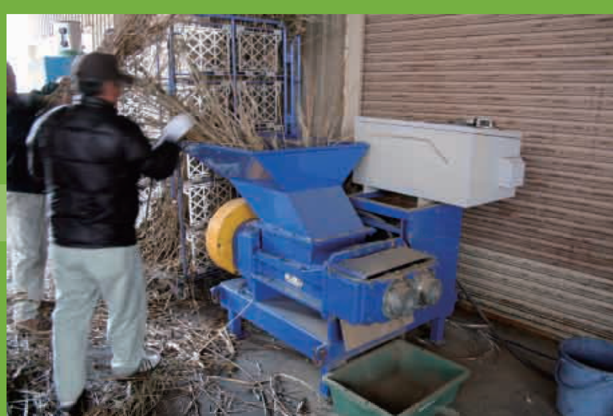
まず、破砕機に入れます。粉末状になったものが下から出てきます。
