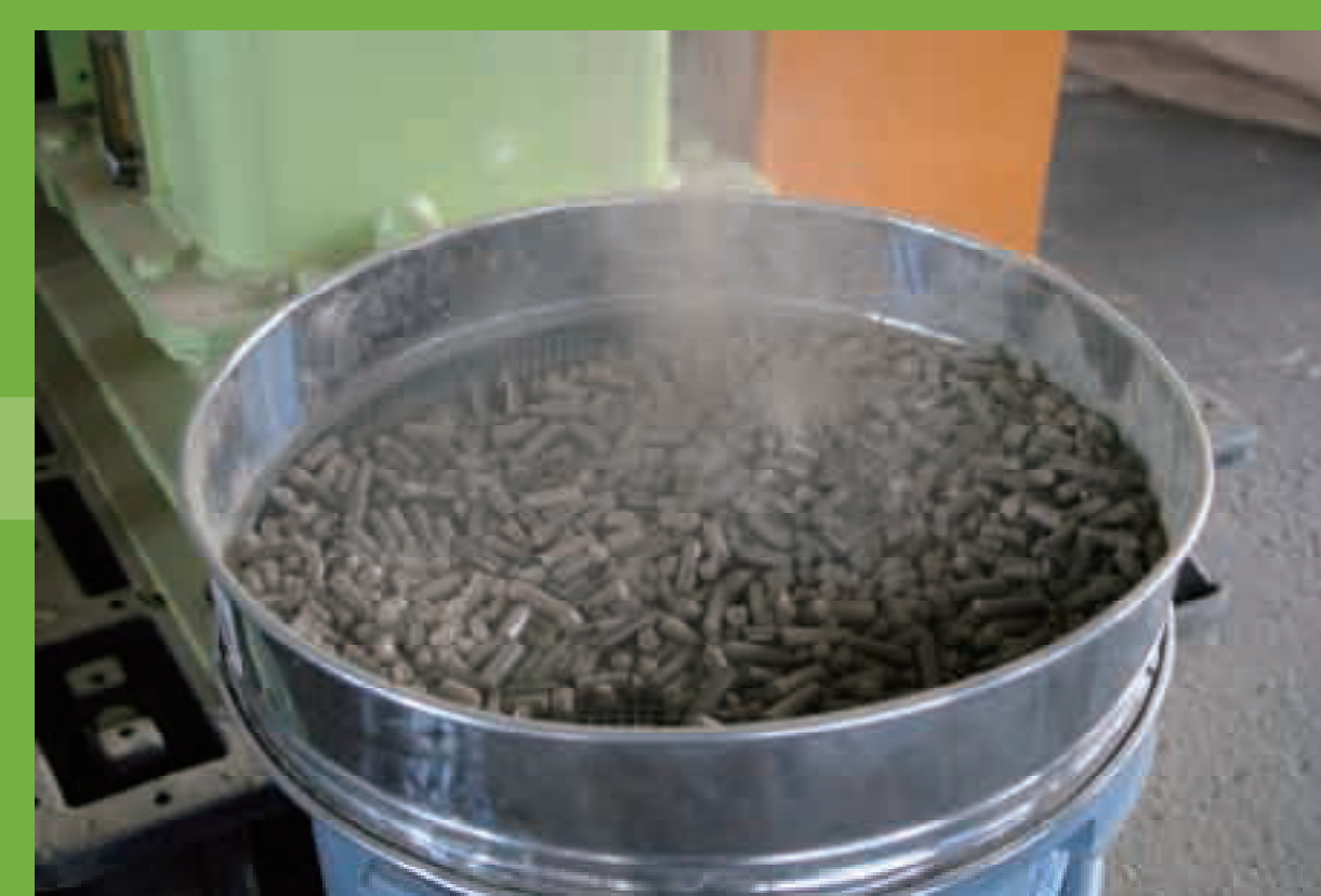
熱をかけて圧縮するので、出来たばかりのペレットはまだ熱い。
